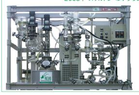
高度なプロセス(固体触媒法等)の技術開発を おこなうために、オールガラス製で設計された 実証プラントです。
